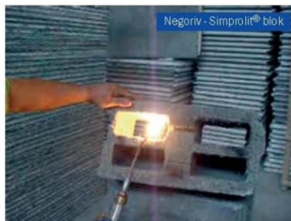
sistem, pri zagrevanju na temperaturi višoj od 240-260°C, prelazi u svoje piroplastično stanje, praćeno smarjenjem mehaničkih karakteristika i razrušenjem sistema pod dejstvom sopstvene težine.
